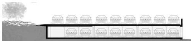
Рис. 3. Разрез наземной двухуровневой открытой автостоянки.
