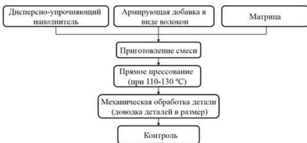
Рисунок 3. Технологический процесс изготовления образцов полимерного композита
